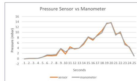
$$p = \frac{Digout(p) - Digout_{min}}{Sensp} + p_{min} \quad \text{with} \quad Sensp = \frac{Digout_{max} - Digout_{min}}{p_{max} - p_{min}}$$
